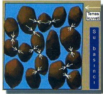
Gözenek suyu basıncının ani artışıyla tanelerin temaslarını yitirmesi
