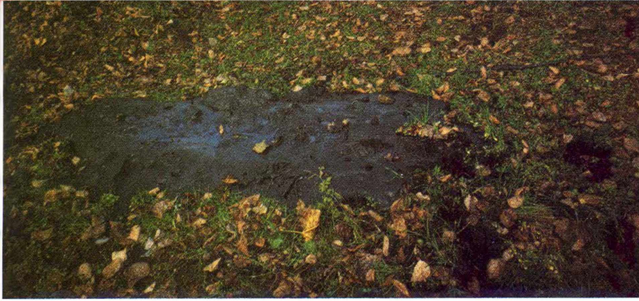
Şekil 10: Yüzeysel kırıntı boyuncu açığa çıkmış sıvılaşmış malzeme.
