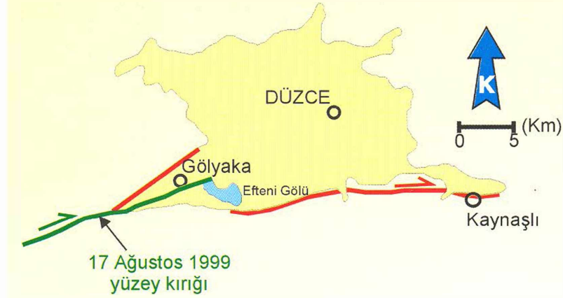
Şekil 6: 17 Ağustos 1999 depremi ile gelişen yüzey kırığı
